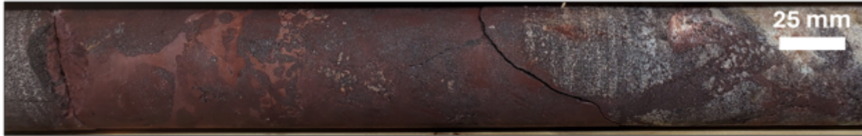
Abbildung 8 - Dravitische Brekzie mit hydrothermale Hämatis, Magnetit und Pyrit aus UR24-03 (752,3 m)
