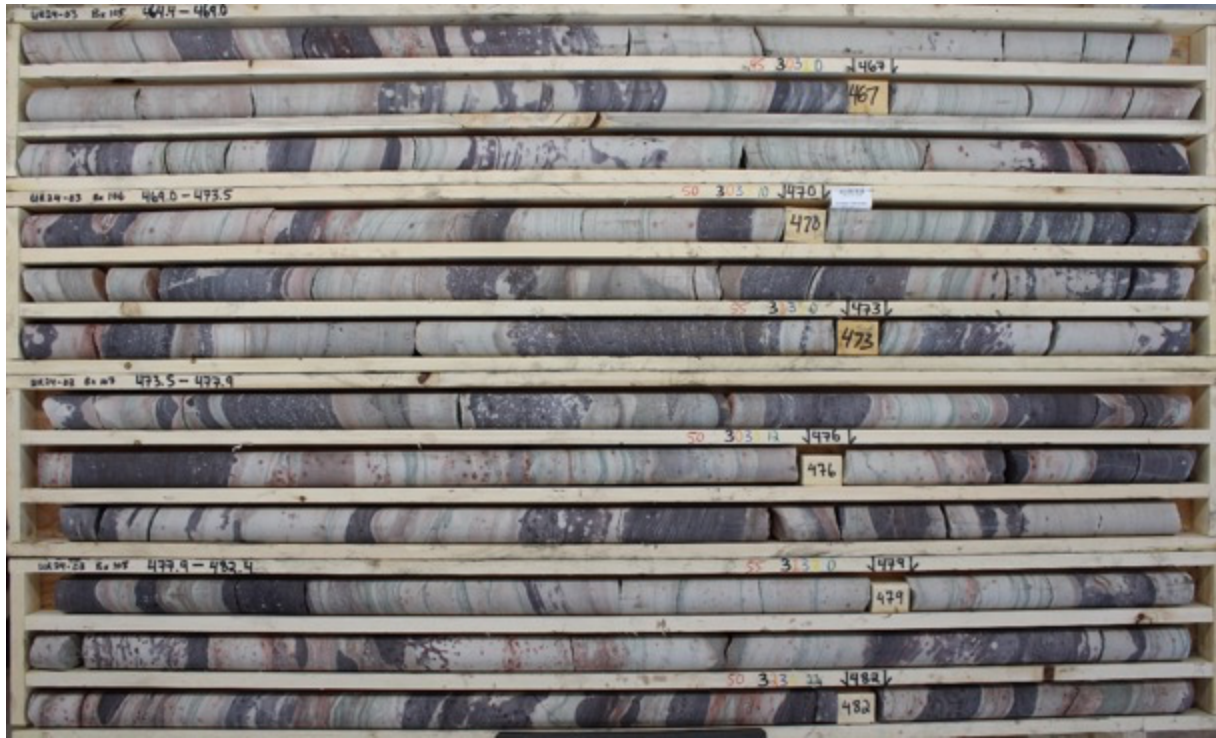
Abbildung 5 - Durchgängig gebleichter Sandstein aus UR24-03 (553,7 - 571,3 Meter) 450 Meter über der Sub-Athabasca-Diskordanz (Abbildung 6 - grün dargestelltes Gebiet)
