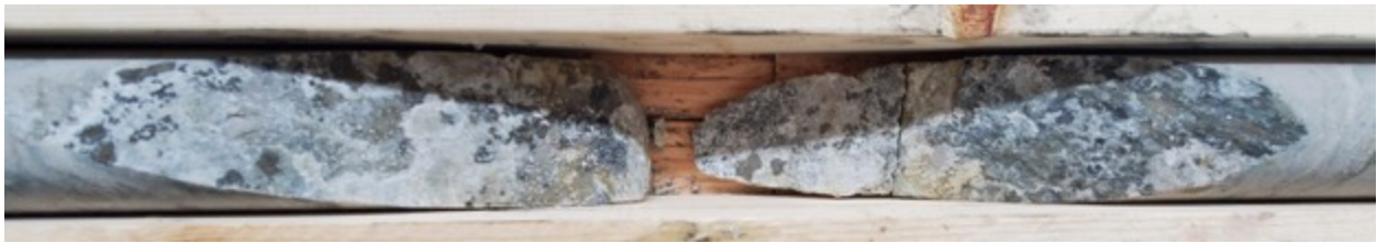
Abbildung 7 - Dravitische Strukturen aus UR24-03 (713,5 bis 715,0 Meter), mit Detail
