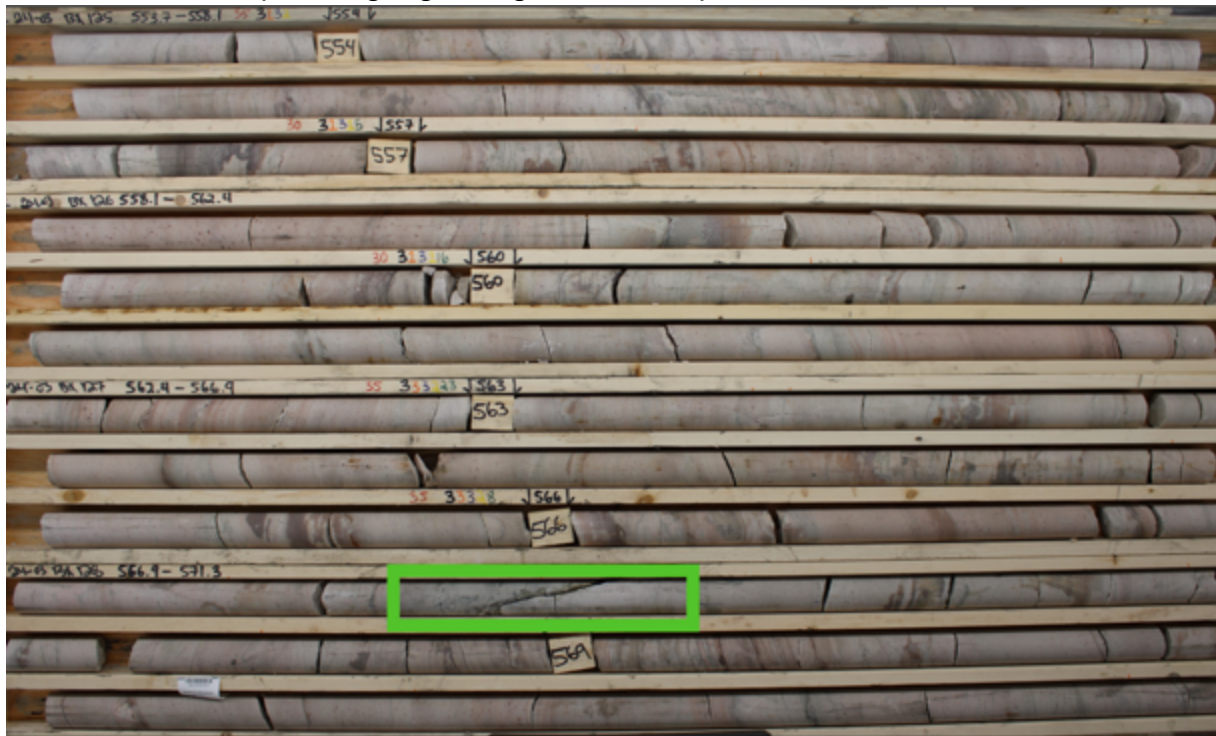
Abbildung 5 - Durchgängig gebleichter Sandstein aus UR24-03 (553,7 - 571,3 Meter) 450 Meter über der Sub-Athabasca-Diskordanz (Abbildung 6 - grün dargestelltes Gebiet)
