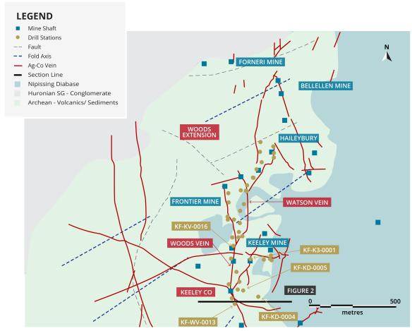
Abbildung 1. Grundgebirgsgeologie und Lage der Bohrstationen des Bohrprogramms 2017. Gezeigte Silber-Kobalt-Gänge wurden aus historischen Karten zusammengestellt und die gezeigten Positionsangaben werden nicht als exakt betrachtet.
