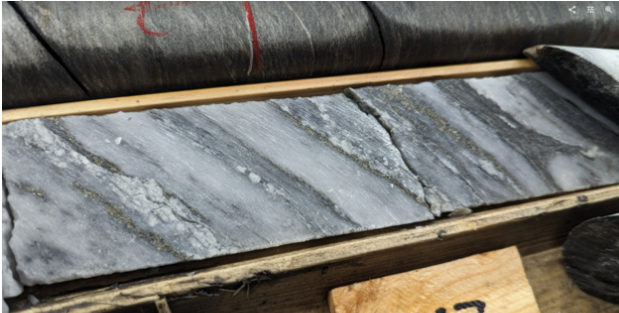
Abbildung 3 - Foto der laminierten Ader aus Bohrloch GTCM23-055, die eine Sulfidmineralisierung zeigt:
