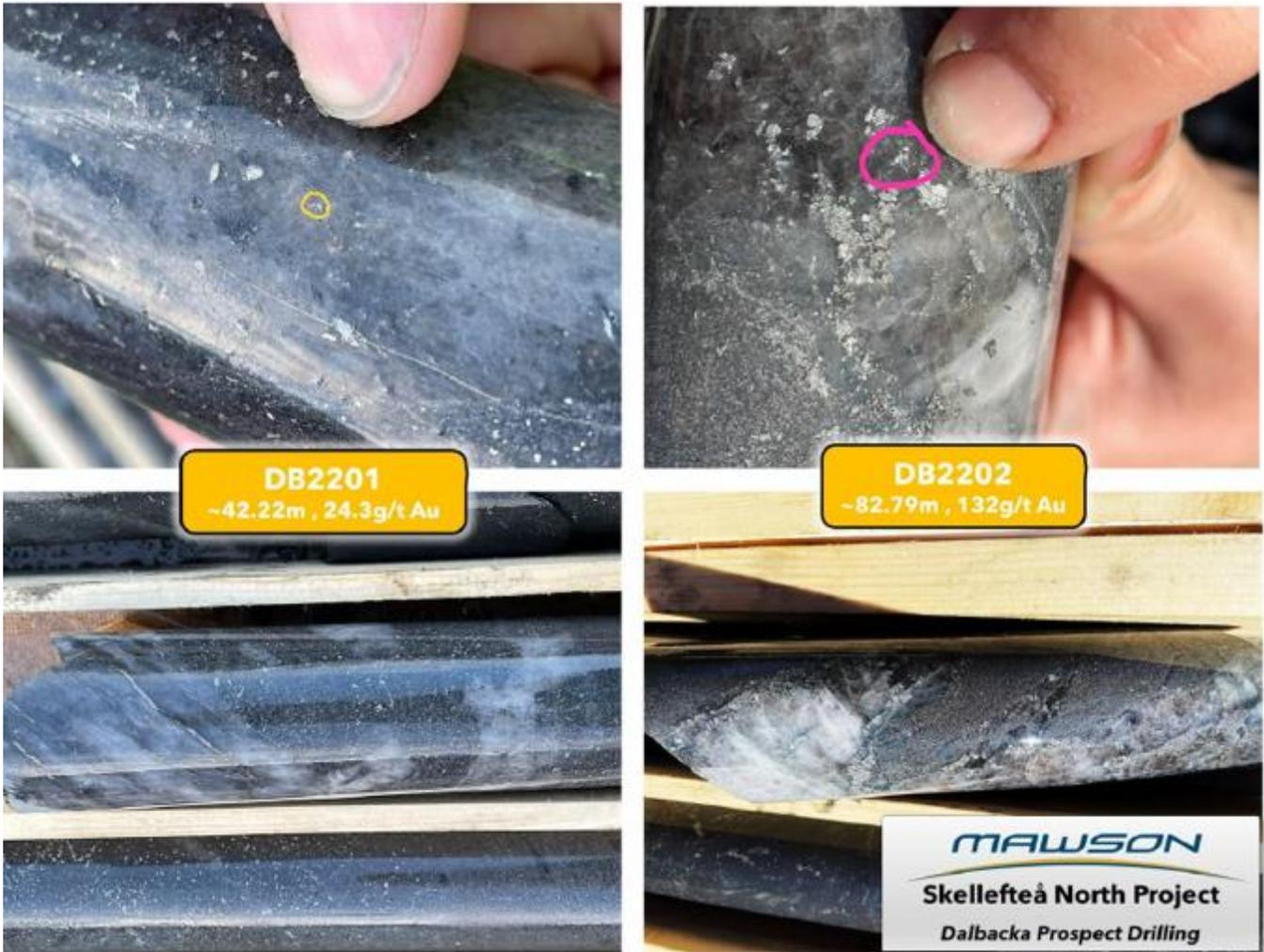
Abbildung 5: Bohrkernfotos der Abschnitte von Bohrloch DB2201, wobei sichtbares Gold eingekreist ist.
