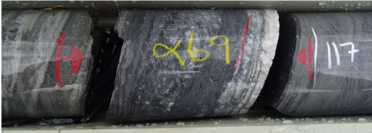
Foto 1: Quarz-Stibnit-geschichtete Scherungsader mit sichtbarem Gold (im Maßstab des Fotos nicht sichtbar) und Stibnit aus 116,9 m im Bohrloch RDDH03. Diese Probe enthielt 0,1 m mit 704 g/t Au und 24,7 % Sb.
