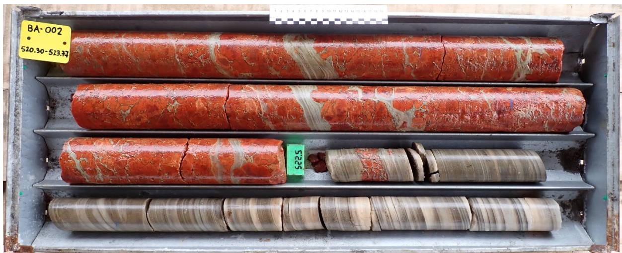
Kalimineralisierung im Bohrkern von BA-002 Extension mit rotem Carnallit, der dem Zyklus IV zugeschrieben wird (Neigung des Bohrlochs = 90°).
