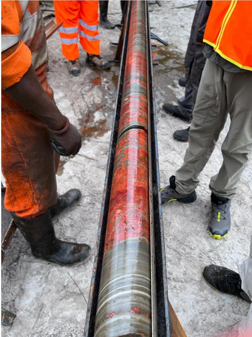
*Kalireicher Bohrkern von BA-002 Extension mit roter Carnallitmineralisierung in einer Tiefe von ca. 519 m.*
