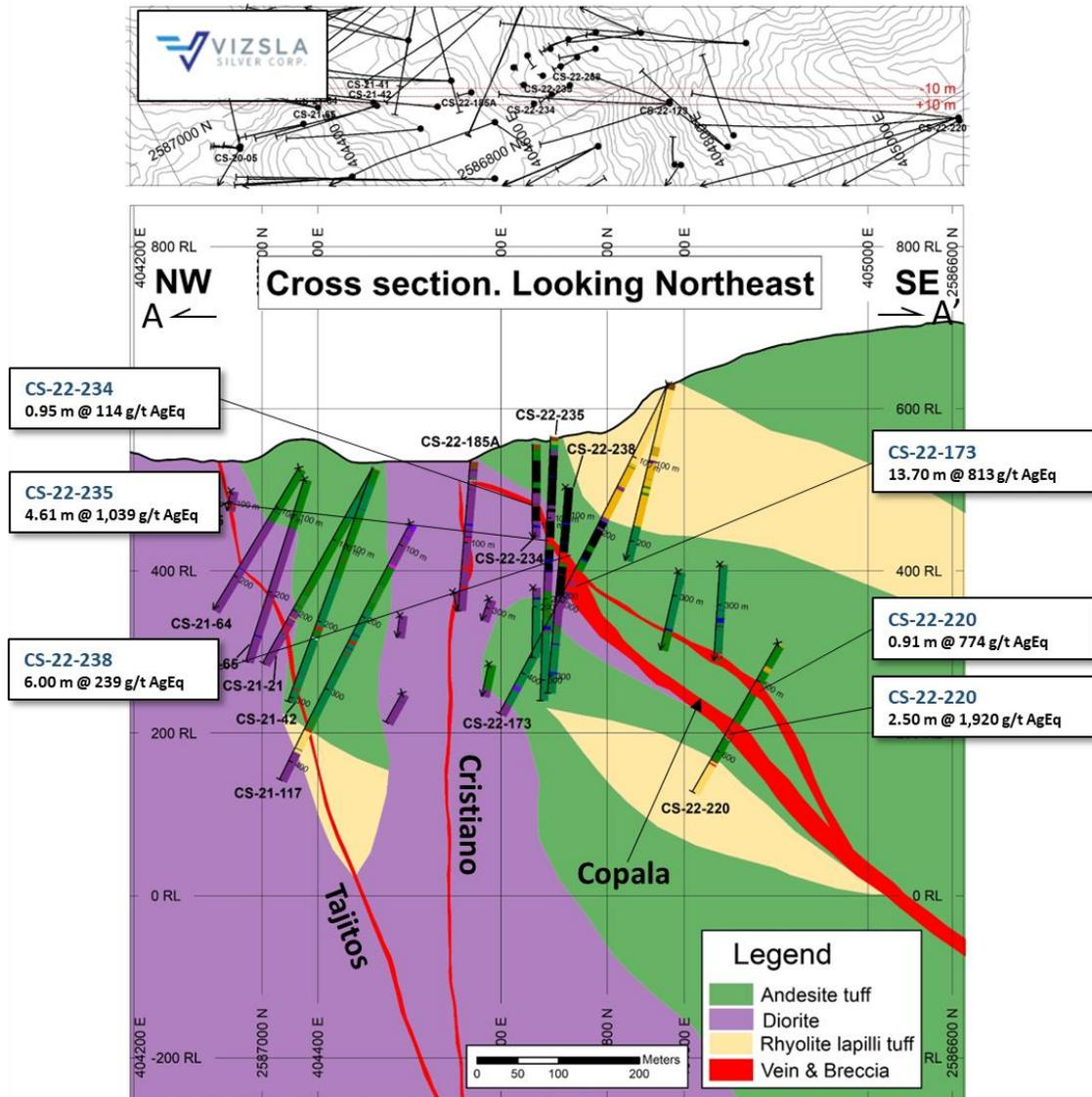
**Abbildung 4:** Profilschnitt mit Erzgängen Copala, Cristiano und Tajitos.
