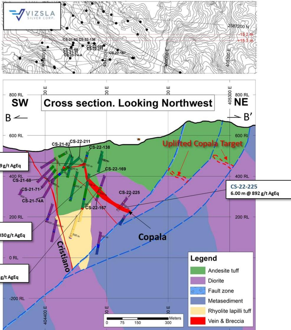
**Abbildung 3:** Profilschnitt mit den Erzgängen Copala und Cristiano und dem Konzept für weiteres Potenzial bei Copala in der gehobenen Scholle im Osten.
