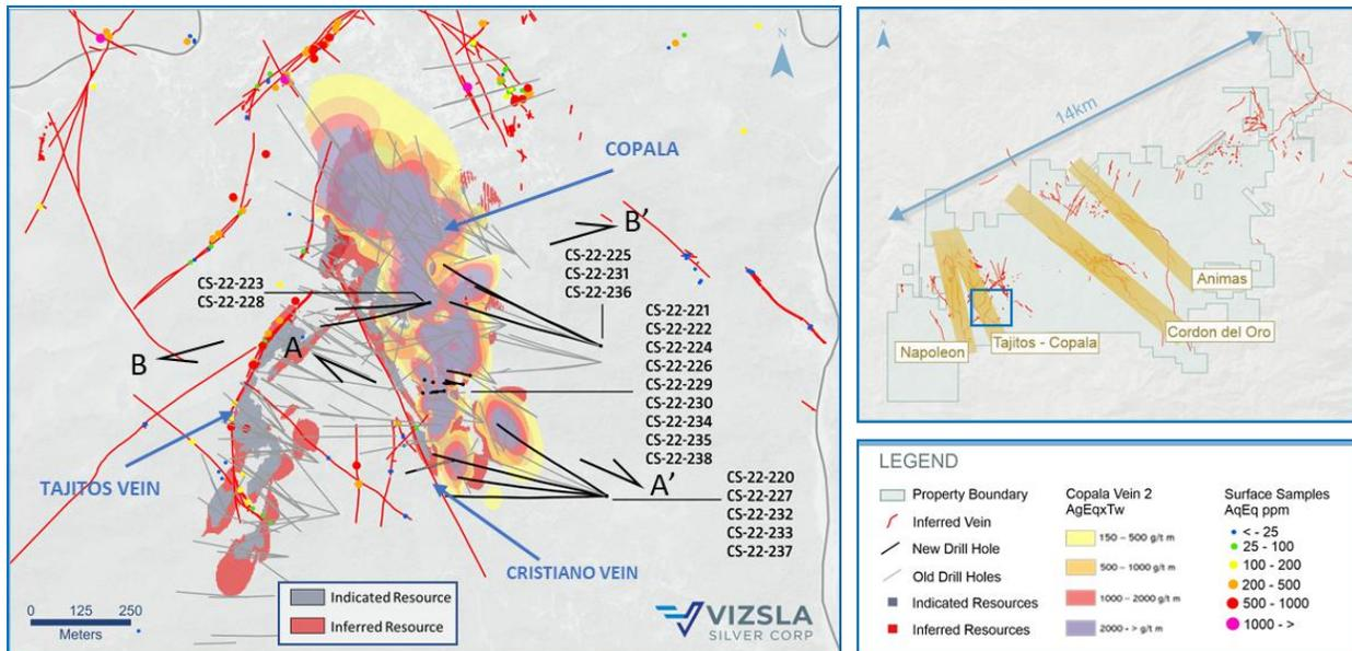
**Abbildung 1:** Übersichtskarte der jüngsten Bohrungen, die sich auf die Copala-Struktur konzentrieren.
