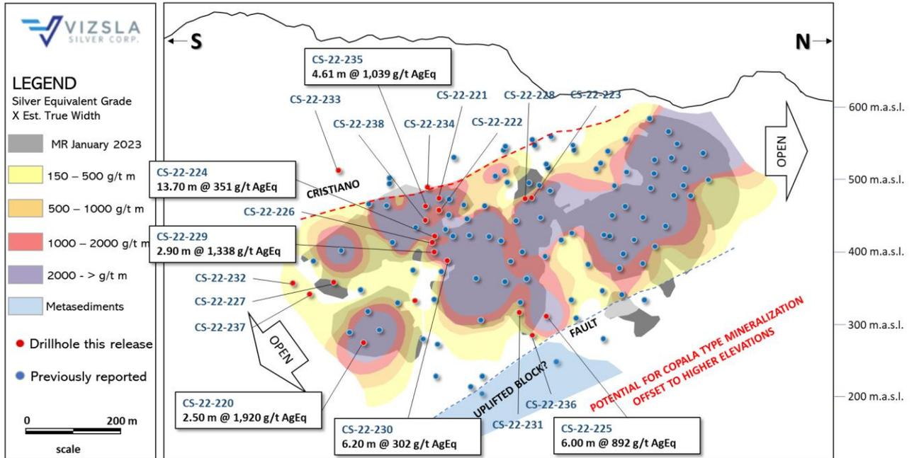
**Abbildung 2:** geneigter Längsschnitt für die Copala-Struktur mit Bohrdurchstoßpunkten. Der Abschnitt ist 1-fach überhöht in Streichrichtung und 1,4-fach überhöht in Fallrichtung, um Copalas durchschnittliches Einfallen mit 46 Grad auszugleichen.
