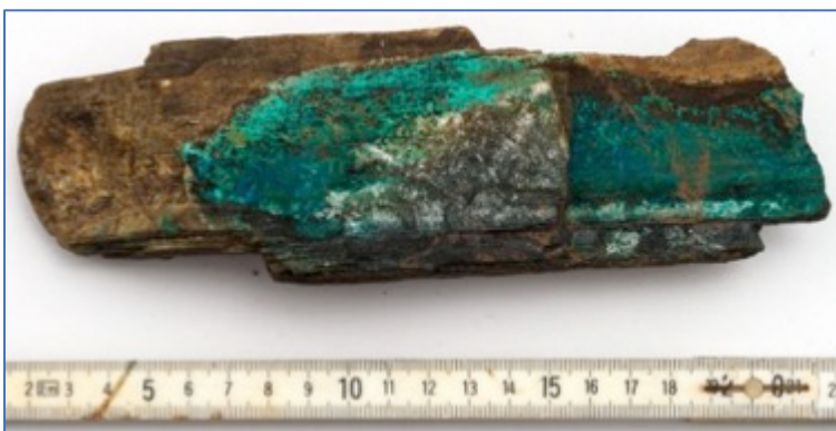
Abbildung 1. Foto einer neuen Stichprobe aus dem Ziel Kirus, die grünen Malachit enthält (Kupferkarbonat). Diese Probe enthält 5,3 % Kupfer und 79 g/t Silber. Das dunkle Hintergrundmineral ist sekundärer Biotit – ein kaliumführendes Alterationsmineral. Der Maßstab ist in Zentimeter.
