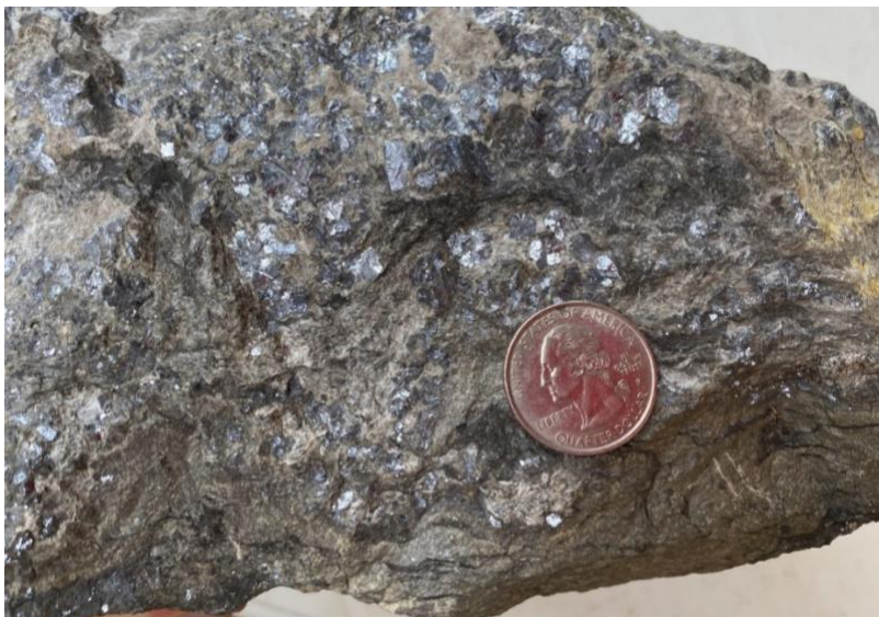
Abbildung 4. Massiver Sphalerit (feinkörnig, braun) und Bleiglanz (grau-metallisch) aus dem Kern einer der hochgradigen Mineralisierungsschichten bei Tiria-Shimpia.
