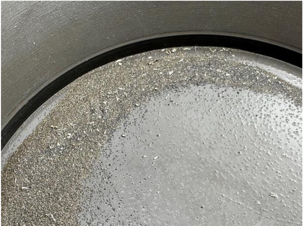
Abbildung 3: Ziemlich reines Awaruit-Konzentrat in einer Goldwaschpfanne. Dieses Material enthielt 50,1 % Nickel. Awaruit liegt in Form von silbrigen Schuppen vor, die gelb anlaufen. Die maximale Korngröße beträgt etwa 2 mm.
