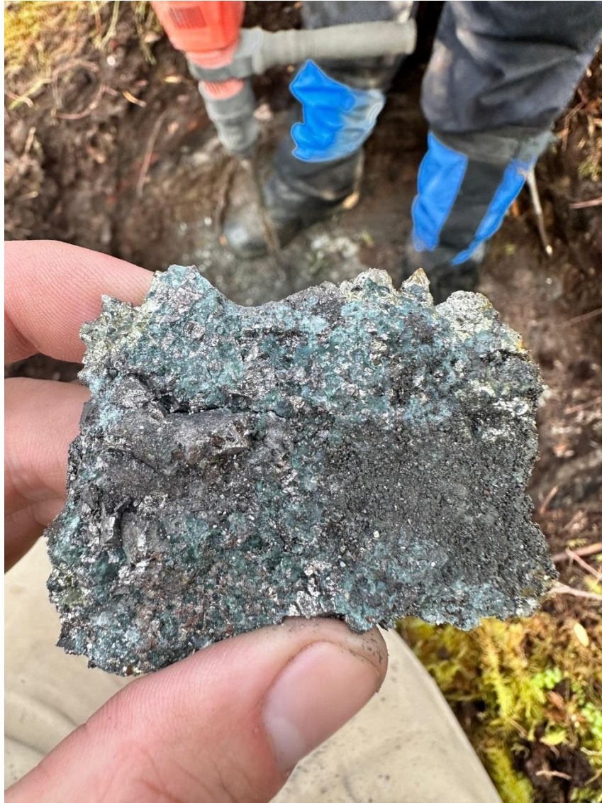
Abbildung 1. Die Stichprobe 344465 zeigt eine Interkumulus-Textur von Pyrrhotin und/oder Pentlandit mit Chalkopyrit und Silikatmineralen.
