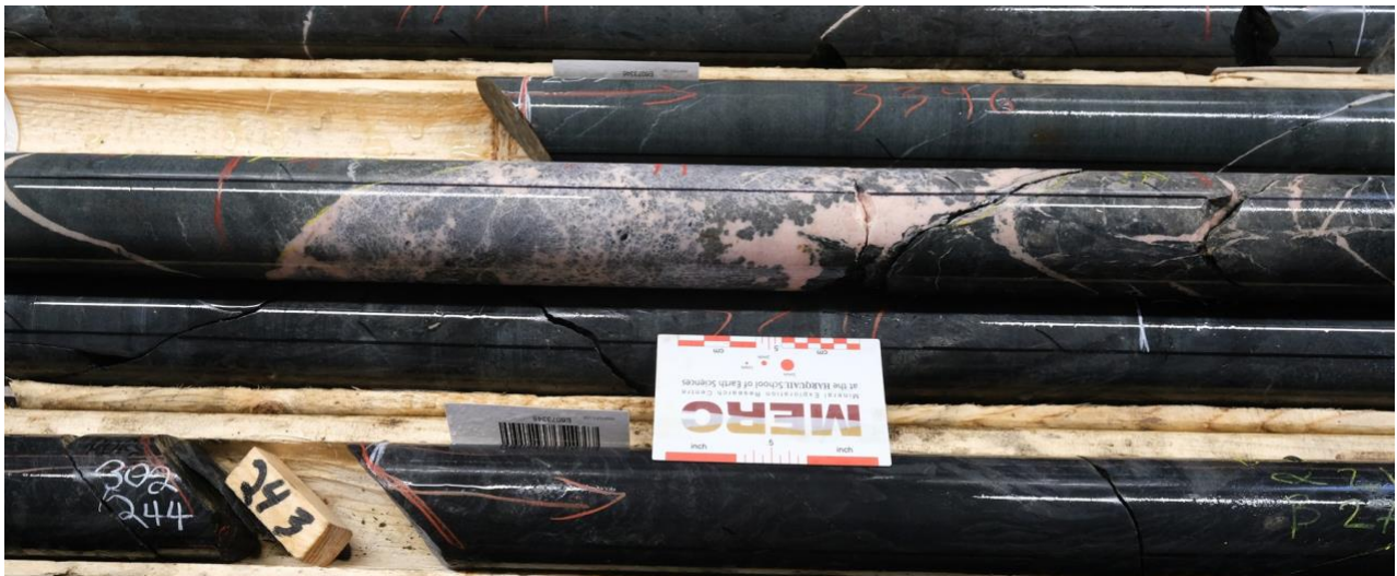
Abbildung 2: Markante rosafarbene Dolomitgänge sind als Mineralisierungsquelle im Kobaltcamp bekannt (Maßstabskarte als Referenz)
