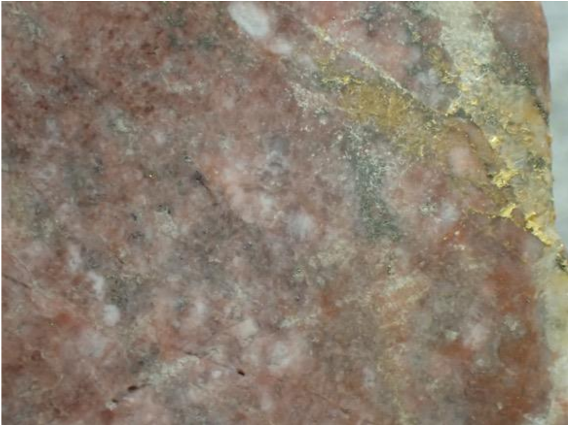
Bildtafel 1: alterierter Syenit mit leuchtend gelbem sichtbarem Gold in Zusammenhang mit kleinen Quarz-Feldspat-Gängen. Beachten Sie auch körnigen silberfarbenen Pyrit. Probe aus 57,6 m Bohrtiefe in DO-21-295 innerhalb eines Intervalls von 1 m mit 334,0 g/t Au. Sichtfeld ca. 20 mm.
