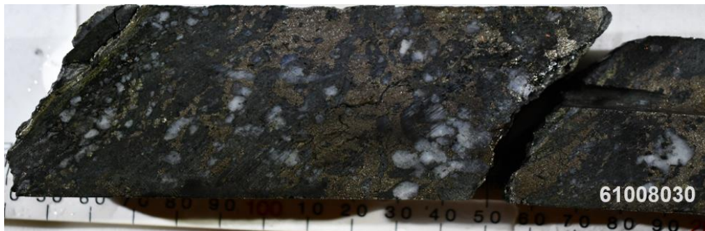
Foto 3: Reichlich Pyrrhotit und Quarz mit Spuren von Chalkopyrit und Pyrit in Verbindung mit Chlorit-Pyrit-Quarz-Scherung (linke Seite des Kerns; aus dem Probenintervall 814,0-814,7 Meter; 0,085 Gew.-% Cu).
