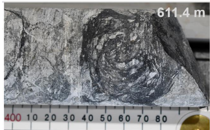
Foto 2: Rotierte kataklastische "Kugel", bestehend aus Chlorit, Graphit, Quarz und Karbonat, innerhalb einer breiten verkrümmten und geäderten Zone mit Serizit-Pyrit-Chlorit-Alteration (611,4 Meter).
