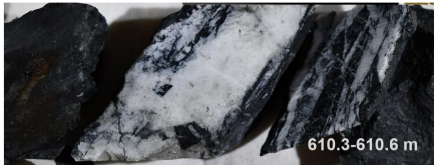
Foto 1: Quarz-Karbonat-Chlorit-Graphit-Adern innerhalb der Zone der Serizit-Pyrit-Chlorit-Alteration (aus dem Probenintervall 610,3-610,6 Meter).
