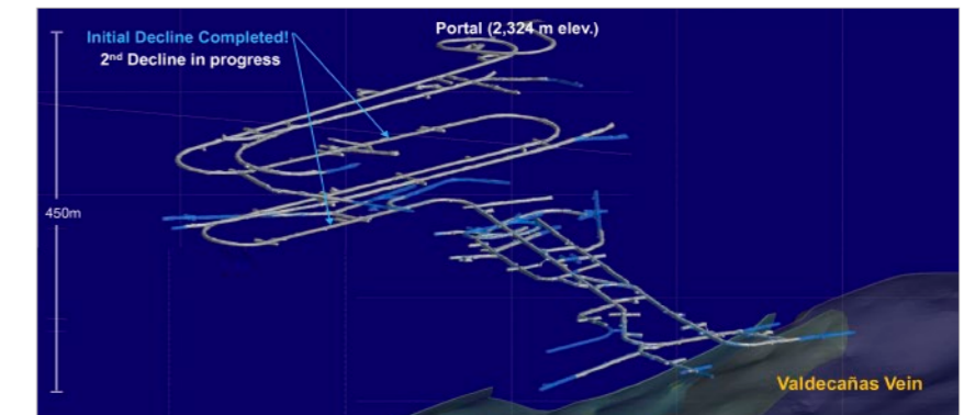
Die bereits gebaute Rampe reicht schon bis an die oberen Silber-führenden Schichten heran.
