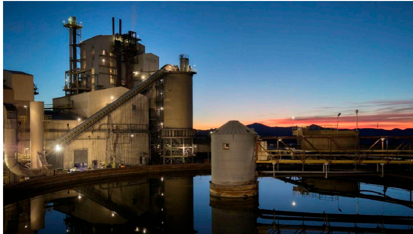
Die Aufbereitungsanlage von Jerritt hat eine Kapazität von 4.500 Tonnen pro Tag und wird derzeit mit einer durchschnittlichen Rate von etwa 2.200 tpd betrieben. (Quelle First Majestic)
